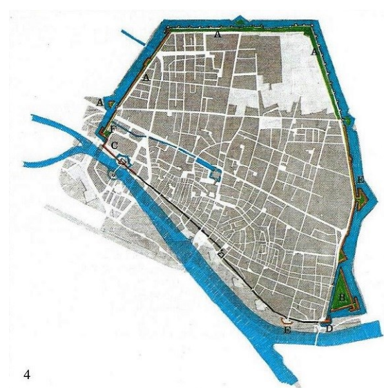
4-Fortificazioni di Alfonso I (1505-1521). A-Concluse le mura di Ercole e innalzato terrapieni. B-Fortezza triangolare fuori dalla Porta di Sotto. C-Trasformato in delizia l'isola del Belvedere. D-Uniti alla fortezza a est i Barbacani di S. Tommaso e di S. Giorgio. E-Aggiunto Baluardo di S. Rocco e di Porta d'Amore. F-Potenziate mura di fronte a Belvedere, riscavato la fossa, creando un barbacane e il Gran Cavaliere.
