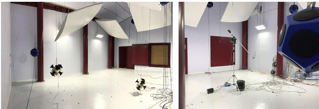
Una **camera riverberante** viene progettata perché si possa generare al suo interno un **campo sonoro diffuso**, caratterizzato da un livello di pressione sonora omogeneo in tutto il volume.
