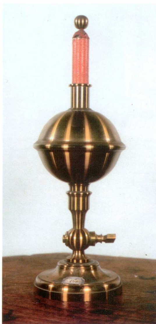
Fig. 1. Apparato di Faraday per lo studio dei dielettrici; non firmato, costruito in ottone e cera, 2ª metà secolo XIX.
