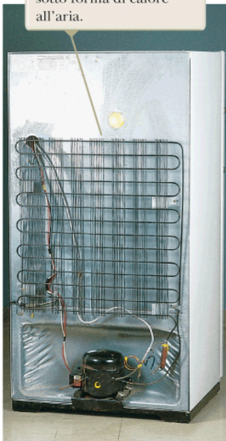
Figura 22.6 Il retro di un frigorifero da cucina. L'aria che circonda le serpentine è la sorgente calda.
