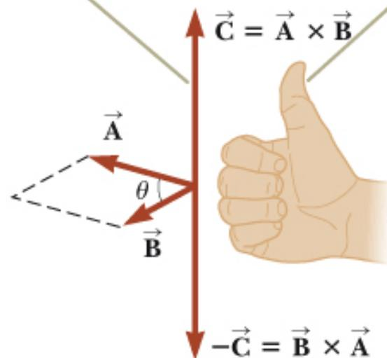
**Figura 11.2** Il prodotto vettoriale  $\vec{A} \times \vec{B}$  è un terzo vettore  $\vec{C}$  avente modulo  $AB \sin \theta$  uguale all'area del parallelogramma mostrato in figura.
