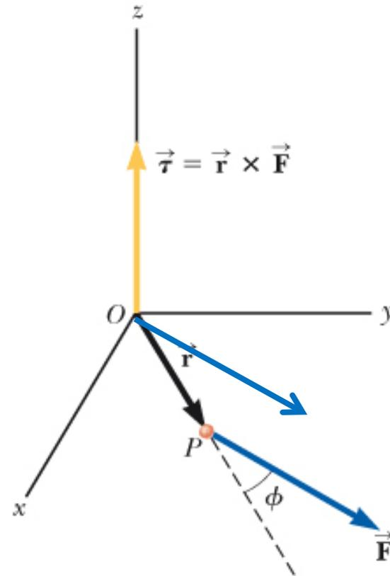
**Figura 11.1** Il vettore momento di una forza  $\vec{\tau}$  ha direzione perpendicolare al piano formato dal vettore posizione  $\vec{r}$  e dalla forza applicata  $\vec{F}$ . Nella situazione mostrata,  $\vec{r}$  ed  $\vec{F}$  giacciono nel piano  $xy$  e quindi il momento della forza è allineato con l'asse  $z$ .
