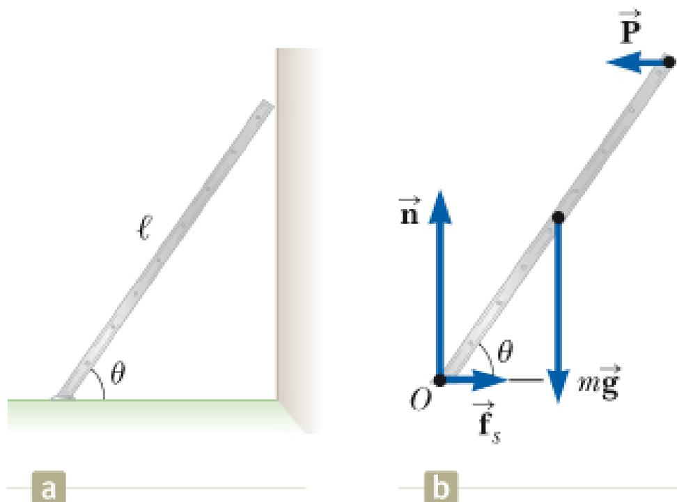
**Figura 12.9** (Esempio 12.3) (a) Una scala uniforme appoggiata ad una parete completamente liscia. Il suolo è scabro. (b) Le forze sulla scala.
