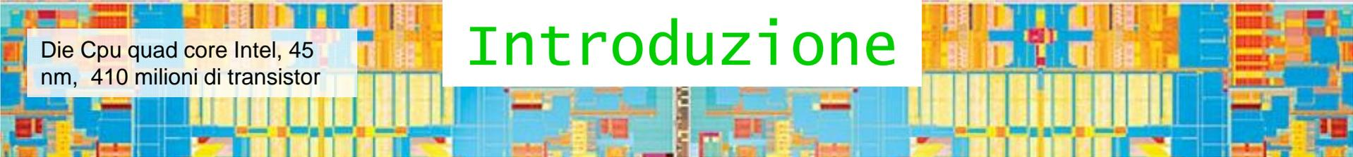
Die Cpu quad core Intel, 45 nm, 410 milioni di transistor
