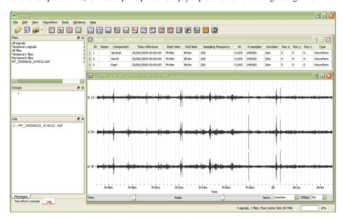
La finestra *Table* riporta le componenti del file e le caratteristiche di acquisizione di ogni canale. La finestra *Graphic* mostra il segnale nella serie temporale.
