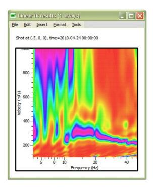
A questo punto è possibile effettuare il picking della curva di dispersione, sia in modalità manuale che automatica, agendo rispettivamente sulle voci *Pick curves* e *Auto pick curves* del menù *Tools*. La finestra che segue mostra come si presenta la finestra nel corso del picking manuale.
