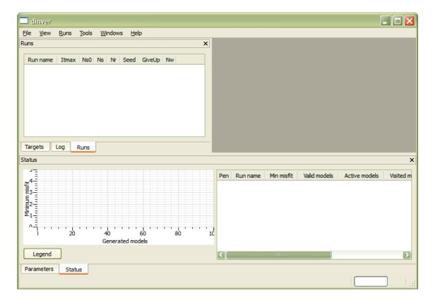
Per caricare i dati della curva di ellitticità calcolata tramite Geopsy va innanzitutto selezionata la sezione *Targets* nel riquadro *Runs*, in alto a destra, tramite l'apposita etichetta, dopo di che si deve spuntare la casella *Ellipticity curve* e cliccare sul pulsante *Set* a fianco, lasciando invariato il contenuto dei campi *Misfit weight* e *Min. misfit*.
