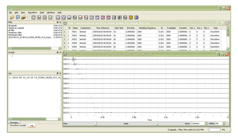
La finestra *Table* riporta le componenti del file e le caratteristiche di acquisizione di ogni canale. La finestra *Graphic* mostra il segnale nella serie temporale.
