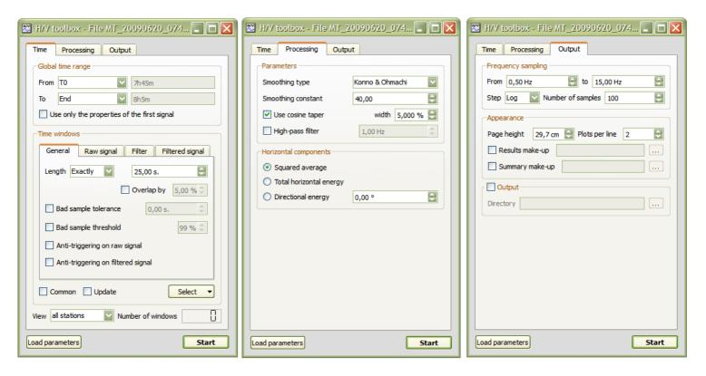
La sezione *Time* permette di indicare i criteri per la scelta delle finestre, tra cui la lunghezza minima e massima e i parametri di funzionamento dell'algoritmo di anti-triggering per l'identificazione e l'esclusione dei transienti.
