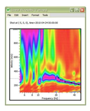
Cliccando con il mouse sopra il grafico è possibile selezionare i punti che, uniti, andranno a formare la curva di dispersione.
