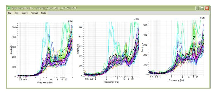
I tre grafici della finestra *Spectrum Results* rappresentano i singoli spettri, nella classica visualizzazione con spettro medio, curve di confidenza e uno spettro colorato per ogni finestra.
