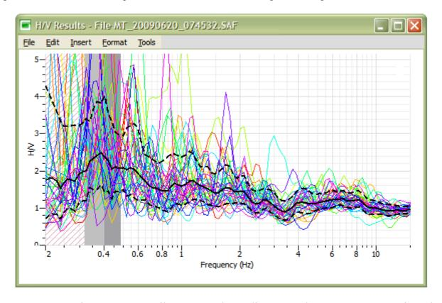
La curva nera continua rappresenta il rapporto H/V medio, mentre le curve nere tratteggiate, dette "curve di confidenza", sono il risultato della moltiplicazione (curva superiore) e divisione (curva inferiore) dei valori del rapporto H/V medio per la deviazione standard dei valori delle singole curve H/V.
