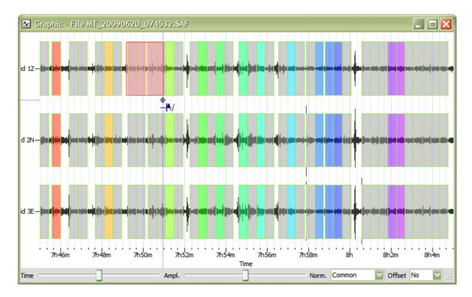
Sono evidenti le finestre temporali colorate di grigio dalla funzione *Reject time windows* e il riquadro rosso che, al rilascio del mouse, causerà la rimozione delle due finestre incluse al suo interno su tutti e tre i canali.
