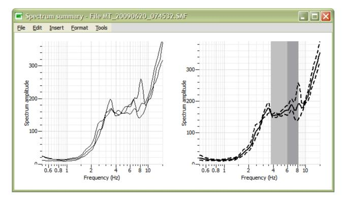
Il grafico a sinistra nella finestra *Spectrum summary* raggruppa gli spettri medi di tutte e tre le componenti; agendo sulla finestra delle proprietà è possibile modificare il colore delle curve in modo da riconoscere a quale componente appartiene ciascuno spettro.
