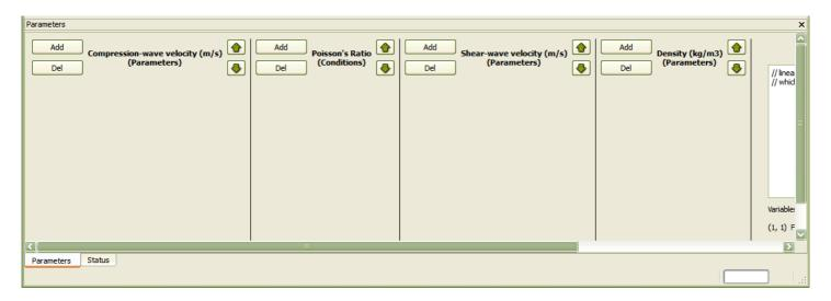
È evidente la separazione dei parametri in 4 sezioni, ognuna delle quali corrisponde a una caratteristica stratigrafica. Per ogni sezione va aggiunto il numero di strati desiderato, cliccando sul corrispondente pulsante *Add*, e per ogni strato inserito vanno specificati lo spessore e i valori caratteristici, fissi o variabili entro un certo range.
