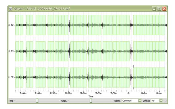
Cliccando sul pulsante *Start* della sezione *Time* si avvierà l'elaborazione H/V vera e propria, che impiegherà più o meno tempo a seconda del numero e della lunghezza delle finestre.
