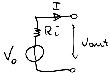
$R_i$  = è una resistenza interna che tiene conto della resistenza complessiva del dispositivo.
