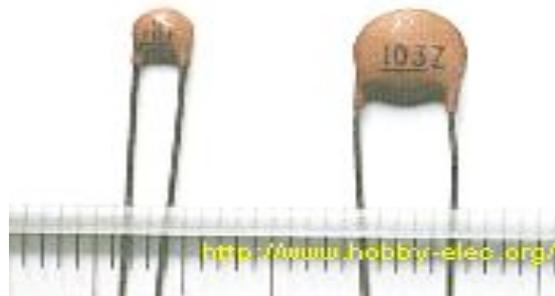
Questi condensatori sono costituiti da strati alternati di metallo e ceramica (da cui il nome) e, viste le dimensioni piuttosto limitate (< 1 cm di solito), valori di capacita' piu' piccole rispetto agli elettrolitici (fino a centinaia di nF). Hanno anche loro tolleranze piuttosto alte (5-10 %) e sono piuttosto economici.
