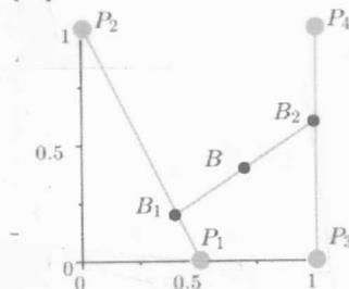
Le asticelle sono unite da un'ulteriore asta  $B_1B_2$  e tutta la struttura è sospesa per il punto  $B$ . I pesi dei punti sono diversi  $P_1$  pesa 4,  $P_2$  pesa 1,  $P_3$  pesa 2,  $P_4$  pesa 3.
