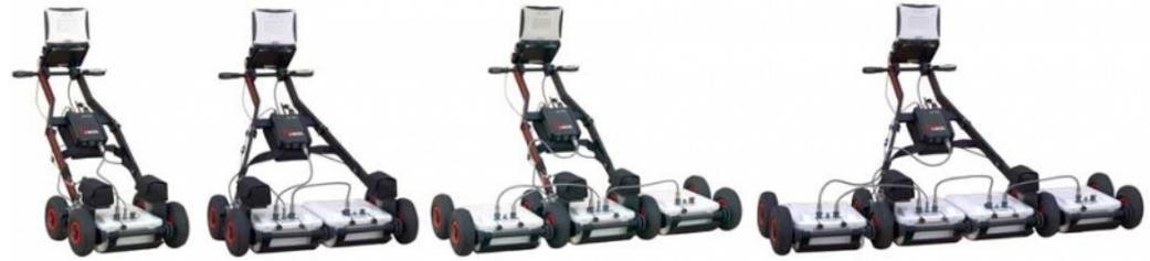
Il georadar è un strumento che trasmette e riceve impulsi di onde elettromagnetiche a frequenza che varia tra 50 e 1500MHz. L'impulso viene inviato ad un'antenna e immesso nel corpo da investigare. Le riflessioni vengono ricevute da una seconda antenna che le manda al sistema di registrazione.
