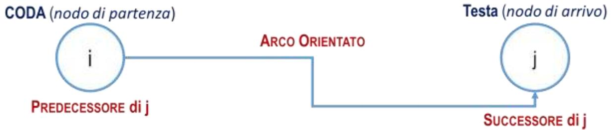
Figura 4 - Schema e definizioni di un arco orientato
