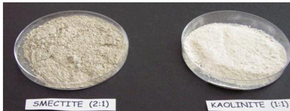
Gli ioni con carica positiva (cationi di silicio, alluminio, potassio, magnesio ecc.) occupano una posizione interna nel reticolo, mentre gli ioni ossidrili o di ossigeno con carica negativa occupano la parte esterna per cui la particella di argilla, pur essendo nel suo insieme neutra, presenta una carica negativa superficiale che costituisce la forza di superficie che dà luogo all'interazione con l'acqua e con gli ioni che sono in essa.
