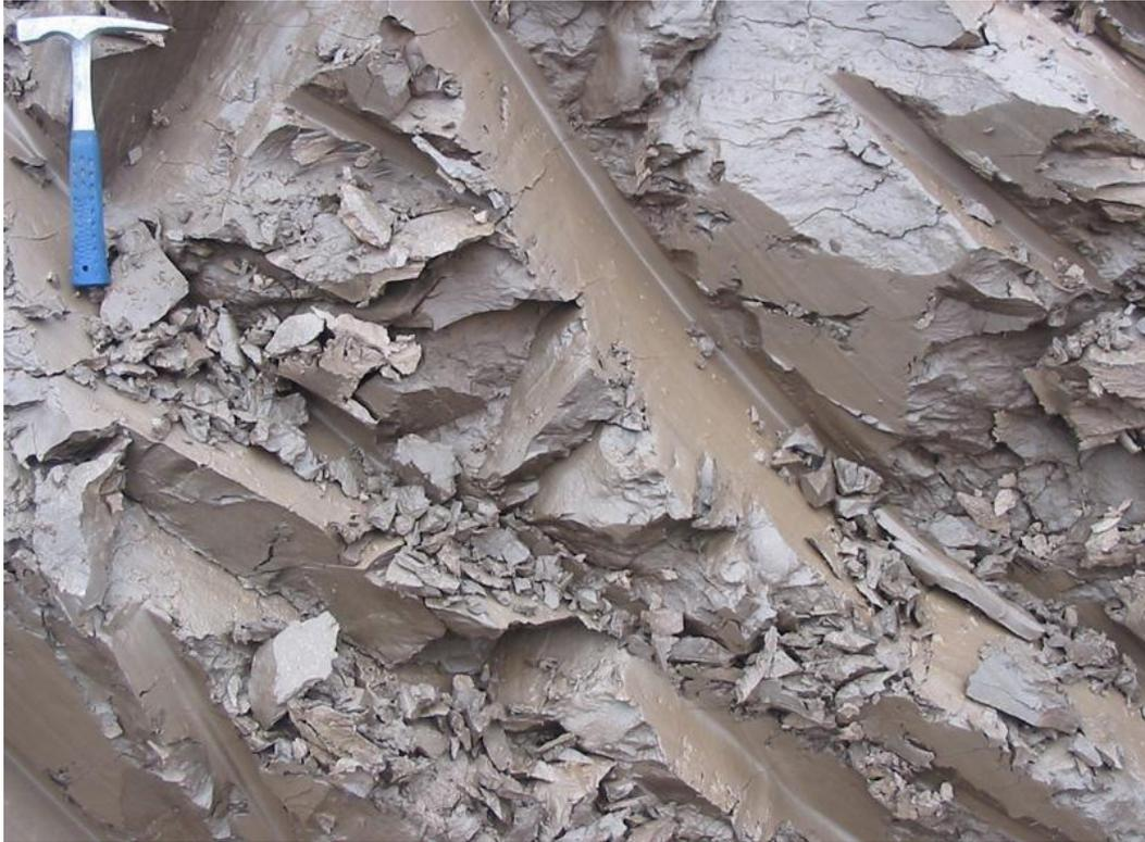
Le dimensioni dei pori sono piccolissime e l'acqua interstiziale può muoversi solo molto lentamente, dando la possibilità all'acqua di entrare in pressione e di portare a rottura il terreno, se adeguatamente sollecitato
