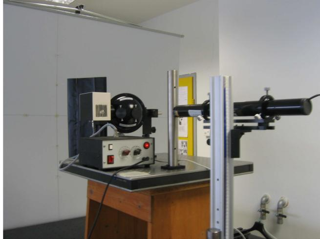
**Figura 4.15:** Allineamento della sfera con il centro dello schermo per mezzo di un laser.
