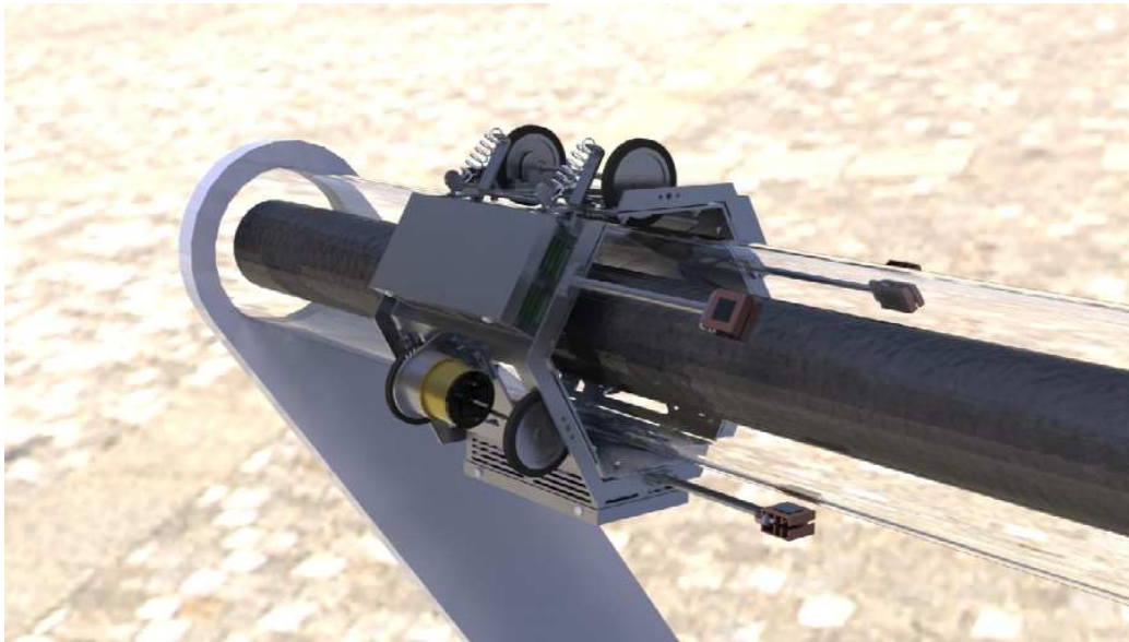
Figura 3.13 – Vista del radiometro montato sul tubo di vetro
