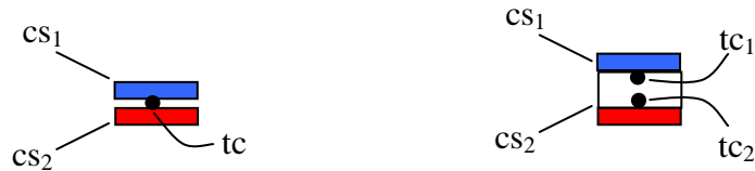
Figura 3.9 - Due celle solari ( cs_1 e cs_2 ) sono accoppiate sulla parte posteriore e tra loro è inserita una termocoppia comune oppure una termocoppia per ciascuna cella
