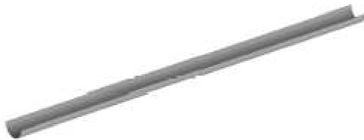
Figura 6.4 - Sezione semicircolare inferiore del tubo ricevitore
