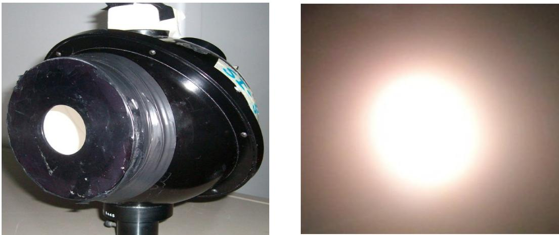
*Figura 3.18:* immagini della sfera integratrice in metallo usata. A sinistra, foto della sfera. A destra, immagine della luce uscente dall'apertura di uscita dello strumento
