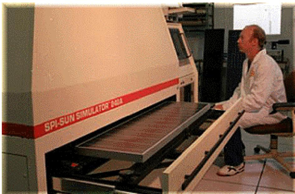
Fig. 20 – simulazione di prestazione di un modulo fotovoltaico in laboratorio.
