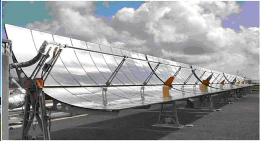
Impianto PCS per prova componenti solari (Centro Ricerche ENEA Casaccia)
