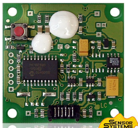
Fig. 22. Inclinometro DAS-360-MA Sensor System
