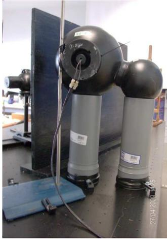
Fig.5.11: Coppia delle sfere integratrici; lo schermo nero separa la sorgente e il concentratore
