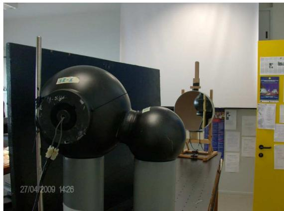
Fig.5.10: SI-1 e SI-3 sui due appoggi ottenuti da un tubo cavo posizionate di fronte allo specchio parabolico; l'apertura d'uscita di SI-3 guarda lo specchio. Dalla foto nello specchio è visibile anche il Rondine già posizionato.
