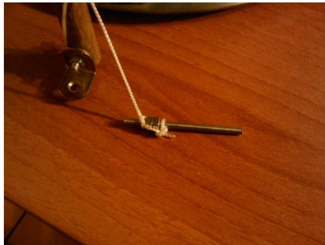
Figura 4.5.22 - Perno ricavato dalla barra filettata
