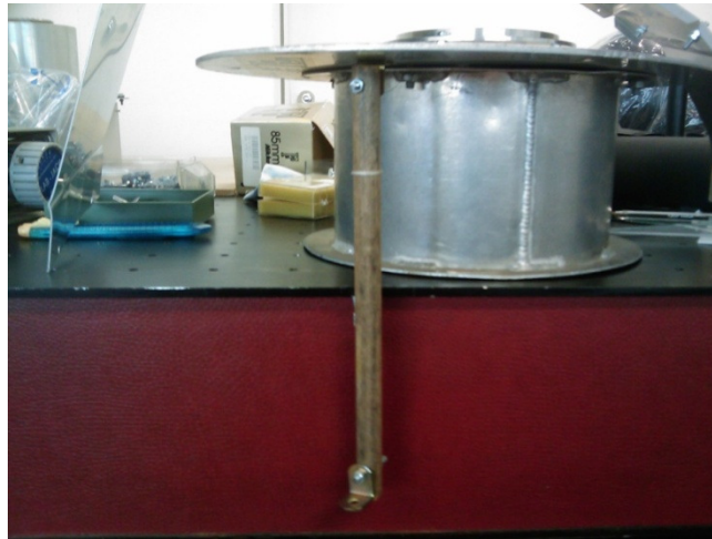
Figura 4.5.21 – Cilindro che collega la base circolare al piatto ellittico
