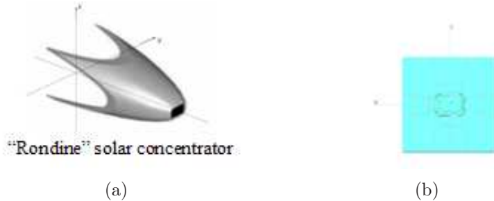
Figura 4.37: (a) Figura della geometria innovativa dell'unità concentrante del modulo Rondine ® , vista di lato; (b) rappresentazione della sezione frontale dell'unità concentrante, la luce che incide frontalmente vede quindi la sezione di un quadrato.
