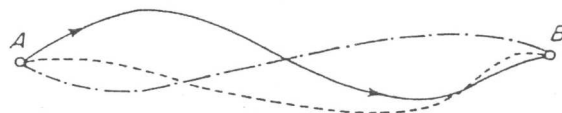
Figura 2.12: Principio di Fermat. Si assume che il mezzo attraversato dalla radiazione abbia un indice di rifrazione che vari con continuità. Il percorso disegnato con la linea piena ha una lunghezza di cammino ottico stazionaria tra A e B, perciò è un percorso fisicamente possibile per un raggio.
