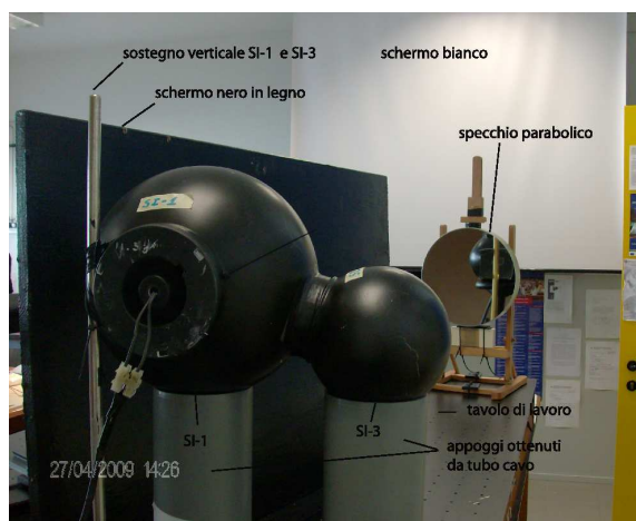
Figura 5.10: SI-1 e SI-3 sui due appoggi, ottenuti da un tubo cavo, posizionate di fronte allo specchio parabolico; l'apertura d'uscita di SI-3 guarda lo specchio. Dalla foto nello specchio è visibile anche il Rondine già posizionato.
