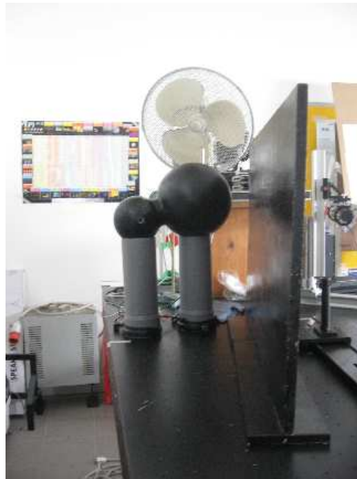
Figura 5.11: Visione frontale della coppia di sfere integratrici e del ventilatore; lo schermo nero separa la sorgente e il concentratore.
