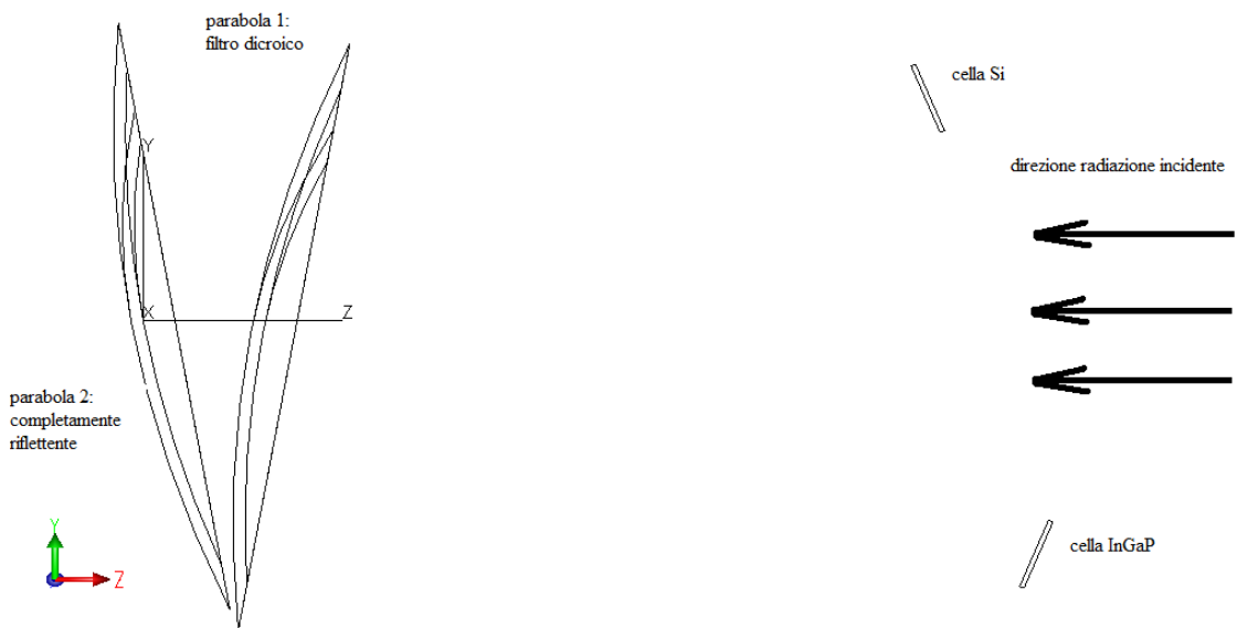
Figura 10.17 Schema del secondo concentratore dicroico simulato
