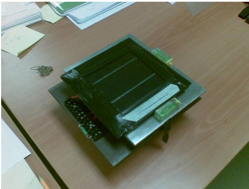
Figura 5.2.5 – Sensore fissato sulla piastra metallica: si possono notare le due livelle per poter mantenerlo orizzontale e i terminali della cella fissati in un mammuth.
