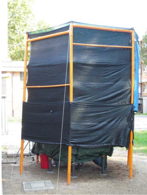
Figura 2.3. Struttura esterna al Morris water-maze. Dalla foto si nota la paratia sostenuta da tubi di PVC. ♣
