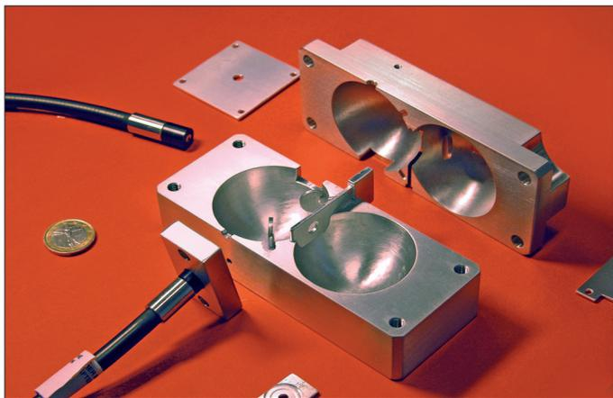
**Figura 2.** Spaccato del radiometro durante la sua costruzione da parte dell'azienda Ecovide [5], prima della ricopertura delle pareti interne con il rivestimento diffusivo di BaSO<sub>4</sub>.
