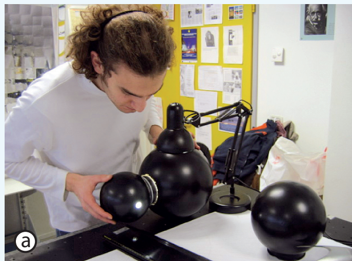
Figura 4. Controllo della lambertianità della sfera integratrice: in (a), la sfera è posizionata sul banco ottico; in (b), la camera CCD è orientata a diversi angoli rispetto alla finestra di uscita della luce. Un comportamento lambertiano della sfera come sorgente di luce si ottiene se l'immagine della finestra ha la stessa intensità in funzione dell'angolo, seppur diversa nella forma.
