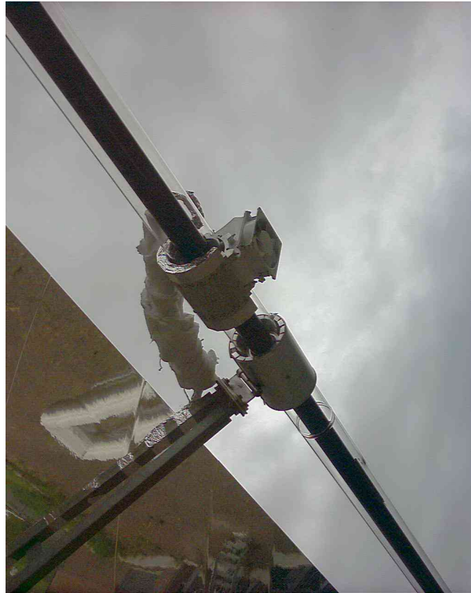
Fig. 4.3: collare-Parretta sul ricevitore PCS nella misura del 10 Agosto 2005.
