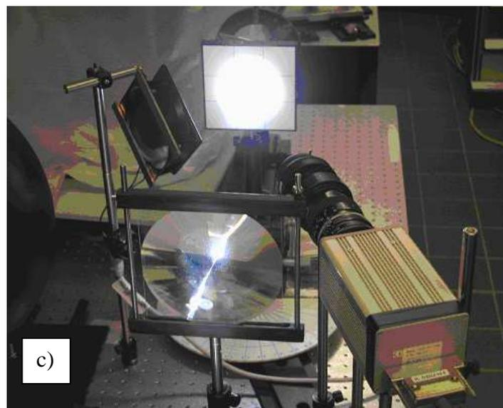
**Figura 20.** Configurazione sperimentale adottata per le misure LS-CCD in riflessione. Sul tavolo ottico (a), in prossimità del target, sono stati montati due diodi laser che servono ad individuare la sezione di test su cui è stato affacciato il diffusore. In b) è mostrato il riferimento (x, y) realizzato con filo nero sul diffusore.
