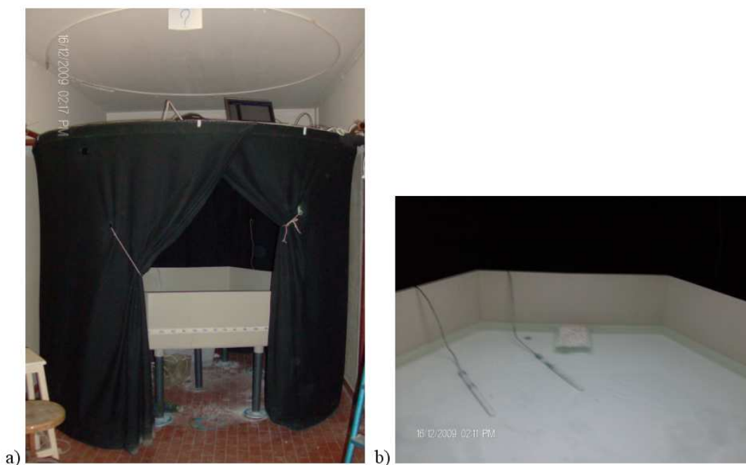
Figura 43. a) Nuovo apparato sperimentale con sorgente TV-LCD. b) Vasca con resistenze riscaldanti (b).
