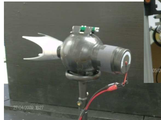
Rondine Gen1 accoppiato con una sfera integratrice per la misura del flusso trasmesso
