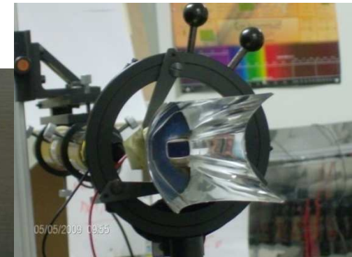
Rondine Gen1 accoppiato con una cella solare per la misura del flusso trasmesso
