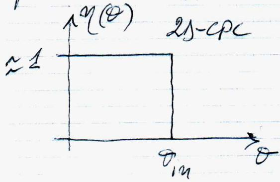
Efficienza minima di un condensatore ideale. I raggi con  $\theta < \theta_{in}$  vengono trasammi per attecchimento, mentre quelli con  $\theta > \theta_{in}$  vengono rifratti indietro.
