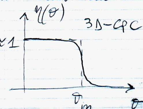
I condensatori del tipo 3D-CPC mostrano una risposta quasi ideale se la loro forma (cavonica) non è alterata ad es. per effetto di un troncamento.
