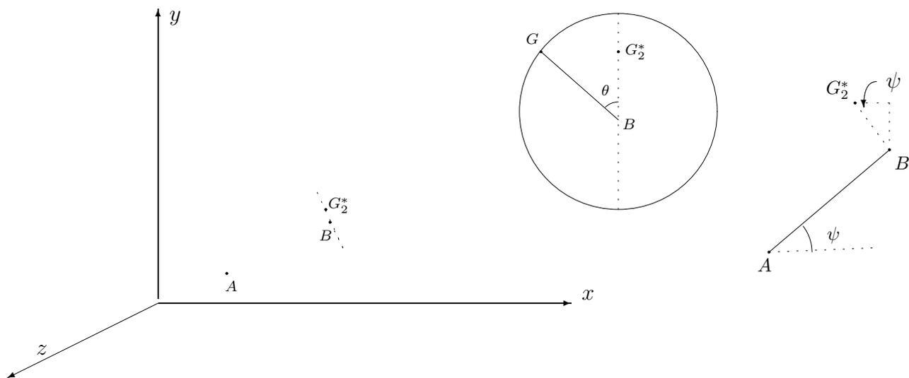
Per valutare la funzione di Lagrange, dobbiamo prima di tutto individuare posizioni e velocità dei centri di massa dei tre corpi rigidi. Indichiamo con  $G_1$  e  $G_2$  i centri di massa di  $AB$  e  $BC$  e osserviamo che solo  $G_2$  si muove fuori dal piano  $Oxy$ : ruota su una circonferenza di raggio  $R$ , centro  $B$ , e perpendicolare a  $AB$ . Abbiamo dunque,
