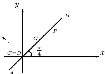
La sbarra ha un punto fisso ( $C$ ) e conviene calcolare l'energia cinetica di rotazione attorno a esso; in figura è segnato con linea tratteggiata l'asse di rotazione passante per  $C$ . La figura si riferisce alle configurazioni istantanee in cui  $A$  raggiunge la quota più bassa: per queste scegliamo  $\theta = 0$ .
