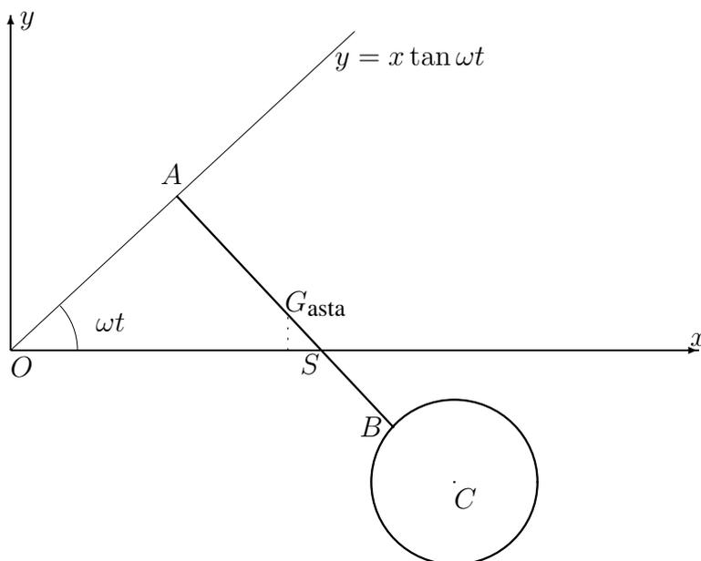
Il sistema ha due gradi di libertà: noto il moto di  $A$  sulla retta, resta individuato ogni punto dell'asta. Poi c'è la rotazione piana attorno all'asta. Supponiamo che il sistema abbia la configurazione mostrata in figura per un intervallo di tempo di sufficiente durata. Scegliamo come variabili lagrangiane l'angolo  $\theta$  della rotazione attorno all'asta, e la distanza  $\rho = \|A - O\|$  del punto  $A$  dall'origine. Dalla figura si deduce immediatamente che
