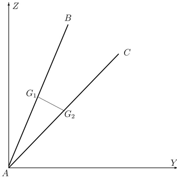
L'estremo  $A$  di un'asta  $AB$ , omogenea, di massa  $m$  e lunghezza  $L\frac{\sqrt{3}}{2}$ , coincide con l'origine di un sistema di assi cartesiani  $OXYZ$ , giace nel piano verticale  $OYZ$  e forma un angolo pari a  $\frac{\pi}{6}$  con l'asse verticale  $OZ$ . In  $A$  è saldata una seconda asta  $AC$ , omogenea, di massa  $m$  e lunghezza  $L$ , che può muoversi nel piano  $OYZ$ .
