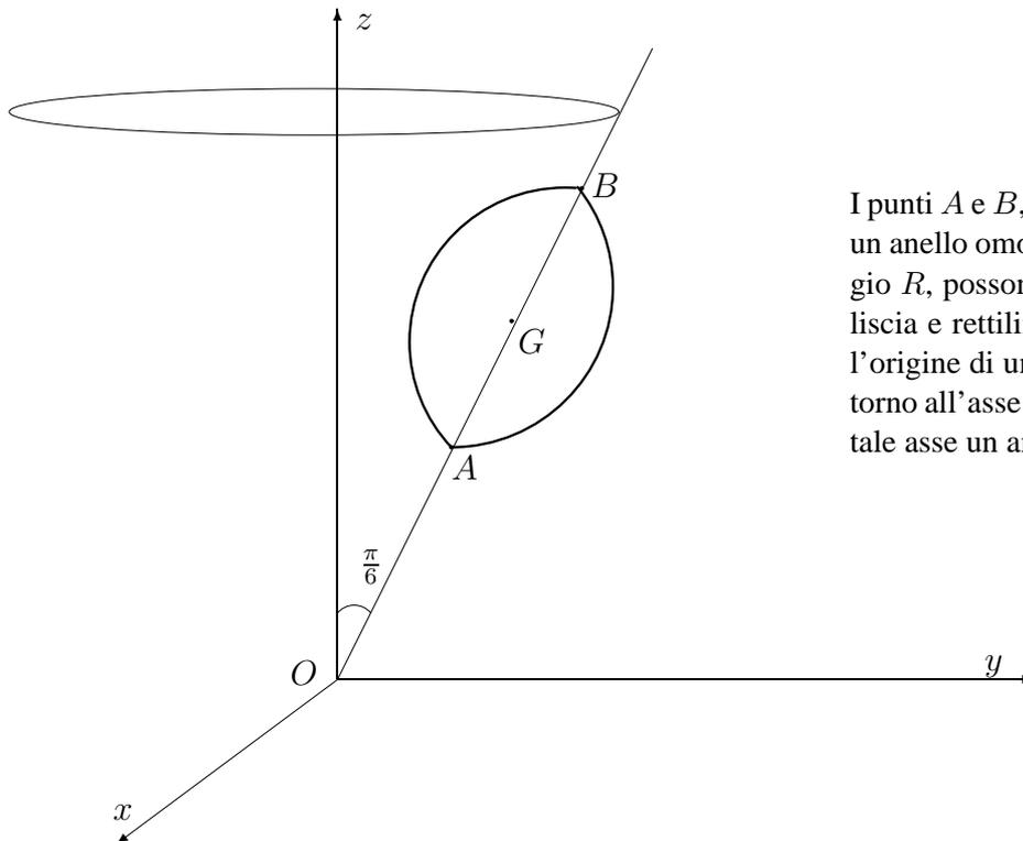
I punti  $A$  e  $B$ , estremi di un diametro di un anello omogeneo, di massa  $m$  e raggio  $R$ , possono muoversi su una guida liscia e rettilinea. Tale guida interseca l'origine di un sistema  $Oxyz$ , ruota attorno all'asse verticale  $Oz$ , e forma con tale asse un angolo di  $\frac{\pi}{6}$ .
