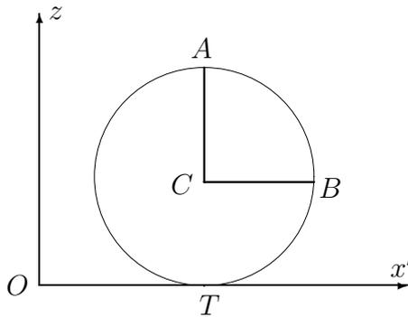
Un anello omogeneo di massa  $m$  e raggio  $r$  può ruotare attorno a un asse orizzontale  $Ox'$  mantenendo fisso su tale asse il punto di tangenza  $T$ . Due aste  $AC$  e  $CB$ , di massa  $m$  e lunghe  $r$  sono saldate all'anello nei punti  $A$  e  $B$  e tra loro nel punto  $C$  in modo da formare un angolo retto. Sapendo che la retta  $Ox'$  si muove con velocità angolare costante attorno all'asse verticale  $Oz$ , si scriva la funzione di Lagrange del sistema.
