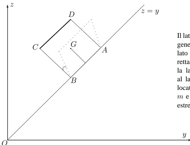
Il lato  $AB$  di una lamina quadrata omogenea, di lato  $L$  e massa  $m$ , è vincolato a muoversi senza attrito lungo la retta  $z = y$  del piano verticale  $Oyz$ ; la lamina è libera di ruotare attorno al lato  $AB$ . Sul lato opposto è collocata una sbarra omogenea di massa  $m$  e lunghezza  $L$  che mantiene i suoi estremi nei vertici  $C$  e  $D$  della lamina.
