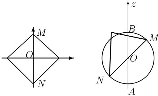
Il sistema ha due gradi di libertà: la rotazione della diagonale  $MN$  e quella della lamina attorno alla diagonale stessa. Siano  $\phi$  e  $\theta$  le corrispondenti coordinate lagrangiane. Notiamo inoltre che il centro di massa del sistema è fisso nell'origine, per cui la funzione di Lagrange si riduce alla
