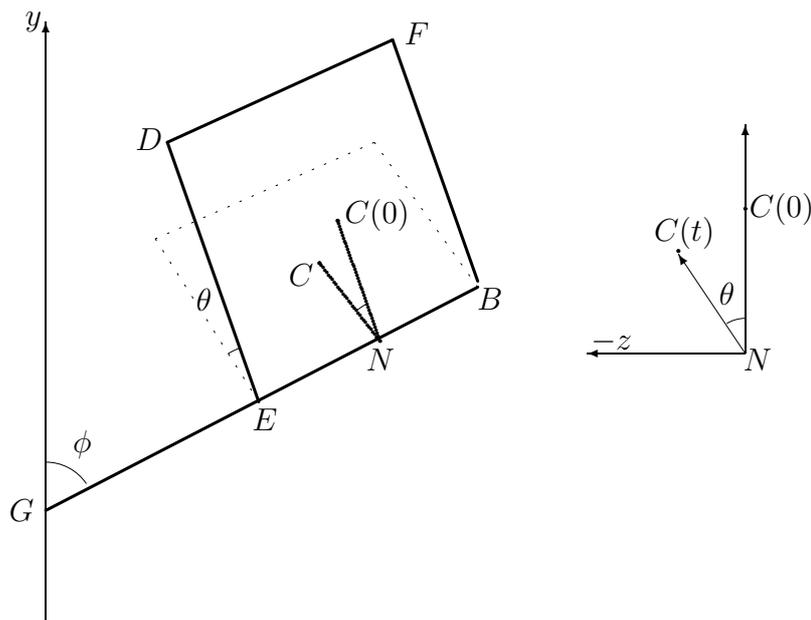
Ma la decomposizione va ora riferita al sistema con origine in  $N$  e parallelo a  $Oxyz$ , dunque è necessaria una rotazione piana di un angolo  $\phi$  in senso orario:
