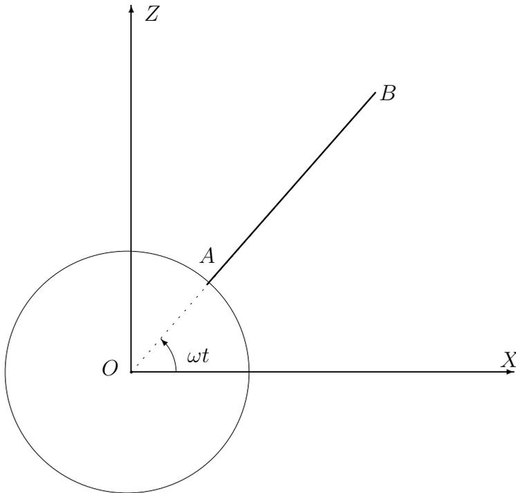
Per determinare l'energia cinetica della sbarra, facciamo uso del teorema di König. Determiniamo prima di tutto la posizione del baricentro  $G$  rispetto a un sistema di riferimento inerziale  $Oxyz$ , per il quale  $Oz = OZ$  e l'asse  $Ox$  forma un angolo  $\theta(t)$  con l'asse  $Ox$ . Questo angolo è anche l'unica coordinata lagrangiana necessaria a descrivere il moto del sistema.
