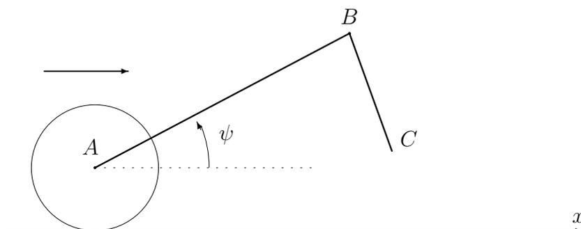
*Il sistema è composto da tre corpi rigidi omogenei: un anello di massa  $m$  e raggio  $R$ , l'asta  $AB$  lunga  $2L$  di massa  $M$ , l'asta  $BC$  di massa  $m$  e lunghezza  $2R$ .*
