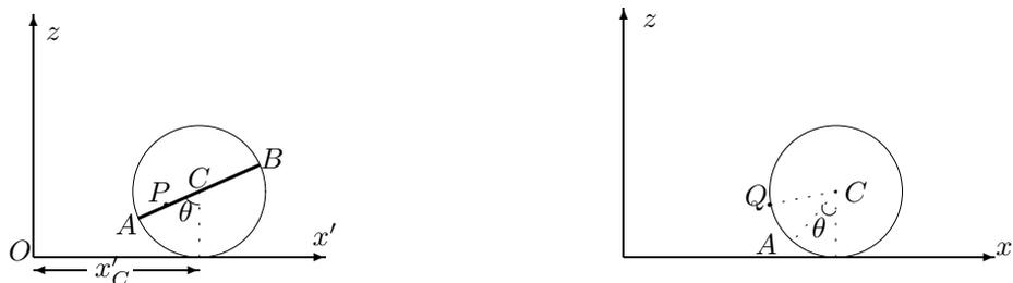
I gradi di libertà sono 2: la rotazione rigida dell'anello (se  $P$  e  $Q$  fossero fissi sull'anello, ciò non inciderebbe sui numero di gradi di libertà), e quella del piano attorno alla verticale. Indicando con  $\theta$  la coordinata lagrangiana corrispondente alla prima rotazione e con  $\phi$  quella della seconda, e tenendo conto che il vincolo sulle velocità si traduce in
