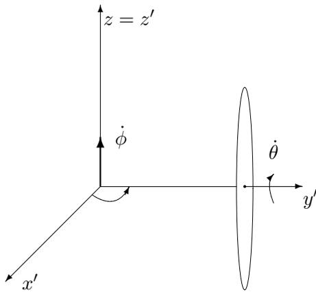
Un disco ruota attorno alla retta  $Oy'$  con velocità angolare  $\dot{\theta}$ . A sua volta l'asse  $Oy'$  ruota attorno all'asse  $Oz$  con velocità angolare  $\dot{\phi}$ .
