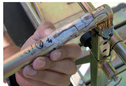
Figura 4 – Maniglia strumentata per la misurazione della forza esercitata dagli atleti nella fase di spinta del bob. (In collaborazione con il Dipartimento di Ingegneria Meccanica dell'Università di Padova).
