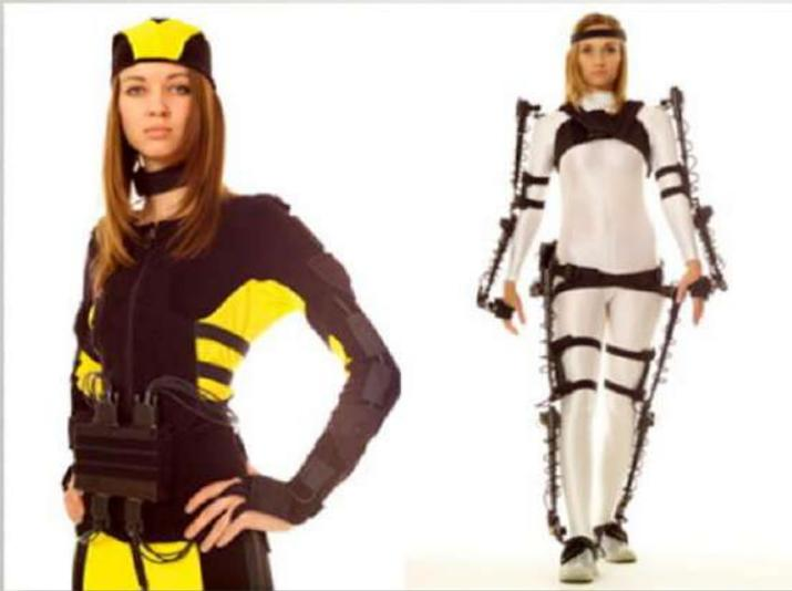
Utilizzano sensori collocati sul corpo per misurare un campo magnetico a bassa frequenza generato da un trasmettitore. I sensori sono in comunicazione con una centralina elettronica di controllo che correla i segnali generati all'interno del campo.
