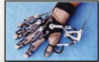
Il data-glove è un vero e proprio guanto, dotato però di sensori in grado di registrare il movimento della mano e delle dita e di inviare al computer le relative informazioni. Accompagnato da un software in grado di interpretare questi dati, il data-glove si trasforma in una interfaccia naturale e potente.
