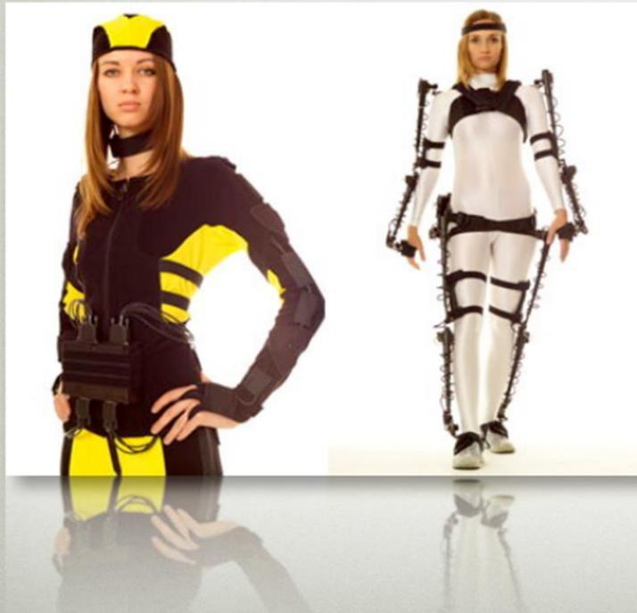
Utilizzano sensori collocati sul corpo per misurare un campo magnetico a bassa frequenza generato da un trasmettitore. I sensori sono in comunicazione con una centralina elettronica di controllo che correla i segnali generati all'interno del campo.
