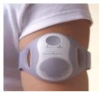
SenseWear Armband - misura dei parametri fisiologici
