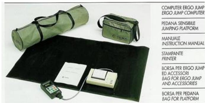
Questo dispositivo è composto da un timer digitale ( $\pm 0,001$  s) connesso, attraverso un cavo, a una piattaforma resistiva o capacitiva.
