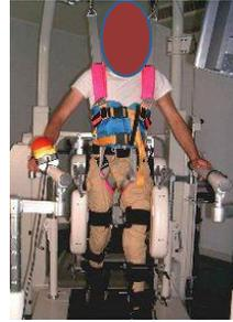
Il robot ad alta tecnologia abbraccia, in una posizione confortevole, i pazienti e li aiuta a camminare su un nastro trasportatore in movimento.
