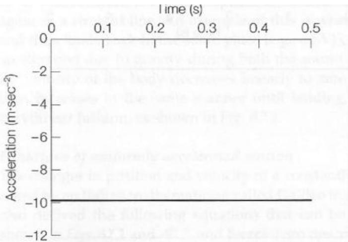
Posizione, velocità e accelerazione del baricentro durante la fase di volo in un salto verticale da fermo.
