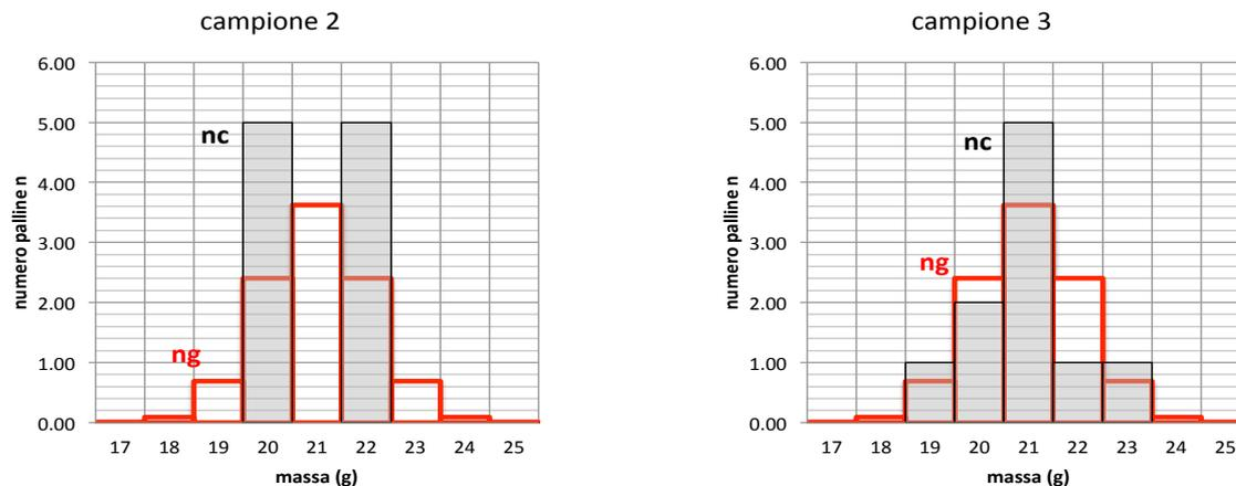
Per passare dalle frequenze relative alle frequenze ovvero al numero di palline atteso in ogni classe è sufficiente moltiplicare la frequenza relativa per il numero totale di palline del campione (10 nel nostro caso)
