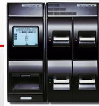
Il sistema di incubazione BacT/ALERT 3D è di tipo modulare. Il modulo di controllo utilizza un disegno a cassette e consente l'incubazione di 240 flaconi per modulo, suddivisi in quattro cassette, contenenti ciascuno 60 celle di incubazione in tre blocchi da venti celle.
