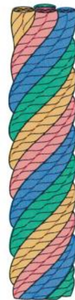
Filamento (quattro protofilamenti avvolti in senso destrorso)
