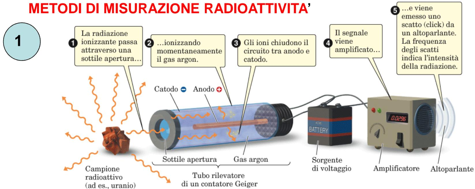
**FIGURA 10.5** Rappresentazione schematica del contatore Geiger-Müller.
