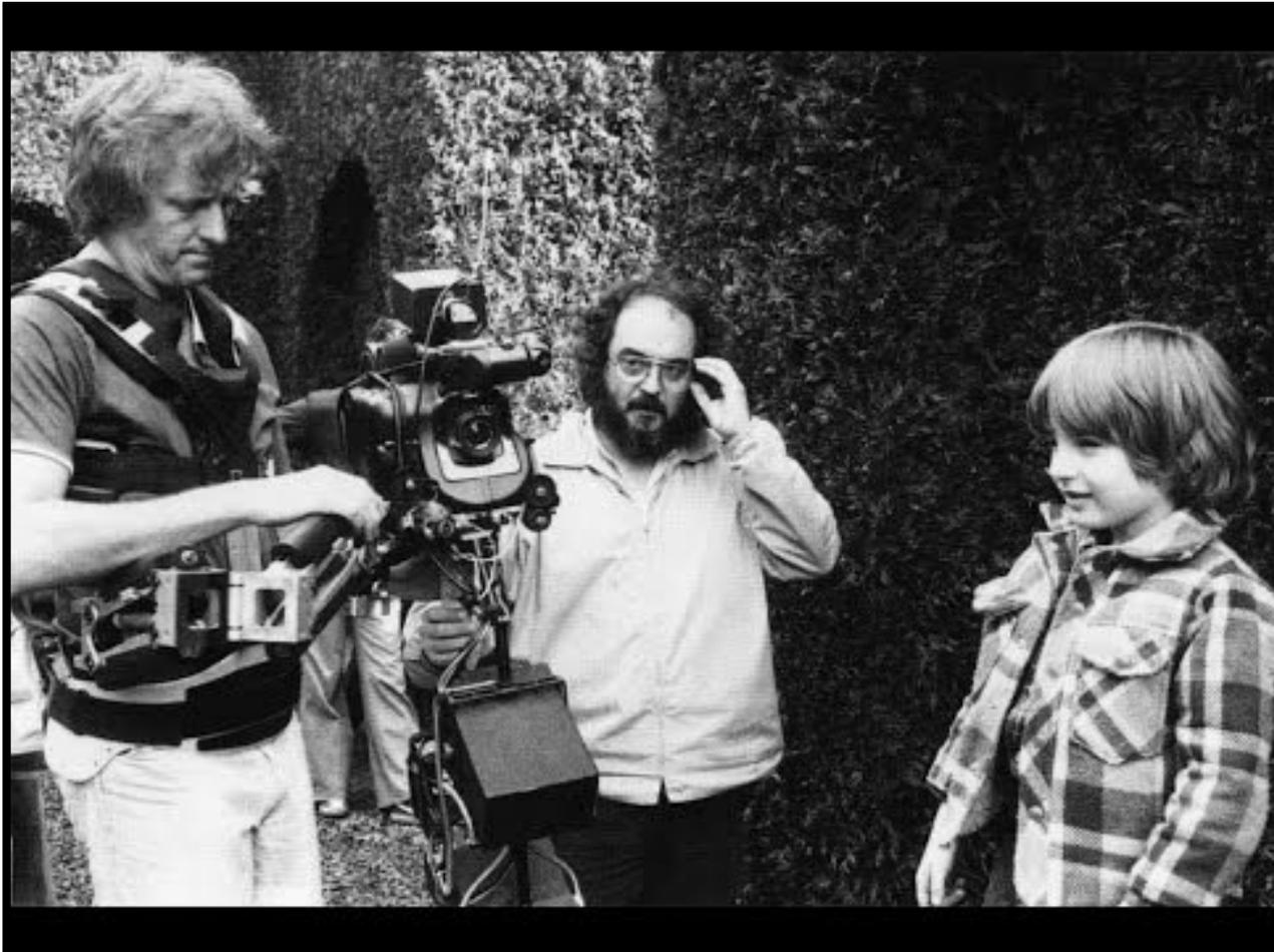
«La **steadicam** è un supporto meccanico, su cui può essere montata una macchina da presa, o una telecamera, sostenuto dall'operatore per mezzo di un sofisticato sistema di ammortizzazione agganciato ad un "corpetto" indossabile.
