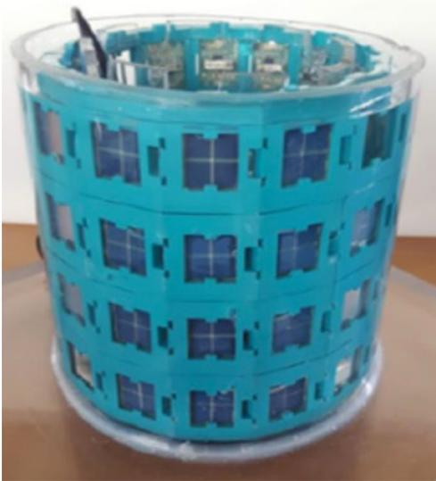
L'invenzione riguarda un **dispositivo solare costituito da un sistema miniaturizzato modulare completamente stand-alone che utilizza l'energia solare per il trattamento delle acque reflue e la contemporanea produzione di idrogeno.**
