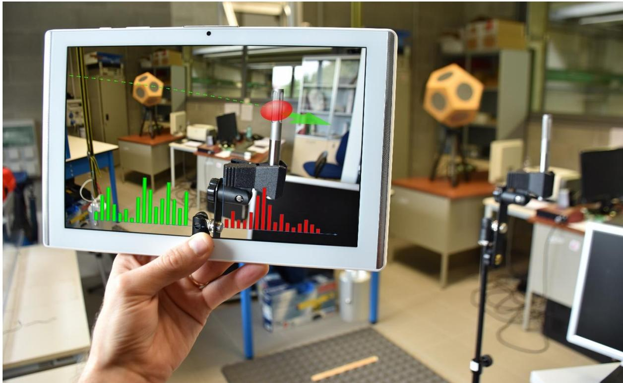
L'invenzione è uno strumento per la misura dell'intensità acustica complessa con risoluzione spettrale tridimensionale radiativa e oscillatoria in qualsiasi condizione operativa.
