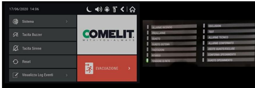
Se la centrale è in **STATO DI ALLARME** (spia
