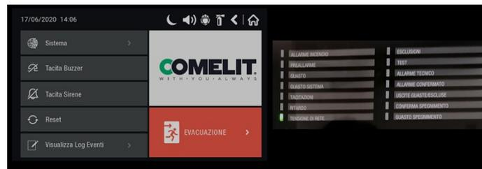
Se la centrale è in **STATO DI ALLARME** (spia
