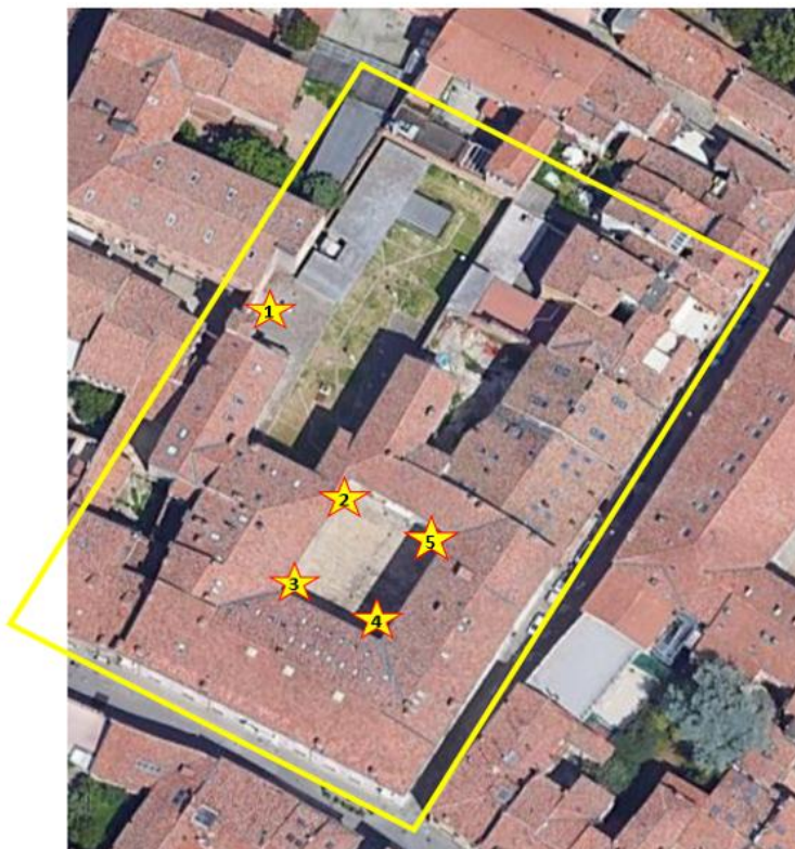
★ ATTACCHI AUTOPOMPA VVF
